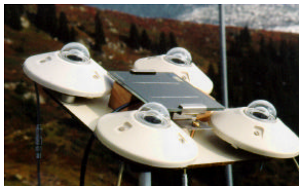
Fig. 16.2.3: Anordnung der Sensoren während des Kalibriervorganges: Referenzpyranometer (oben links), ESTI-Zelle (Mitte) und drei Feldpyranometer. Das Bild entstand in Disentis-Caischavedra während der Kalibriermessung vom 18. September 1996.
