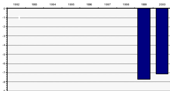
Fig. 11.2.9: Differenz der Strahlungssummen zwischen Pyranometer- und Referenzzellenmessung [%]
